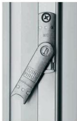
Elemento DUO- Función: El seguro de falsa manobra evita que pueda moverse la manilla, para evitar daños tanto en la ventana como en el herraje y a su vez el elevador de hoja que se encarga del correcto posicionamiento de la hoja sobre el marco.
